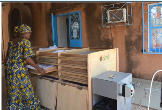
Séchoir « Flux traversant » CSec-T (© T. Ferré, Cirad)
